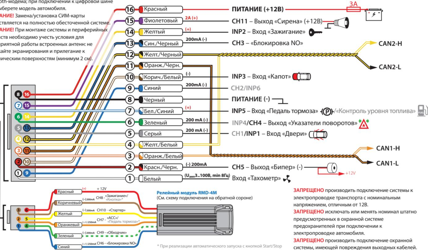
**ЗАПРЕЩЕНО** производить подключение системы к электропроводке транспортса с номинальным напряжением, отличным от 12В.
