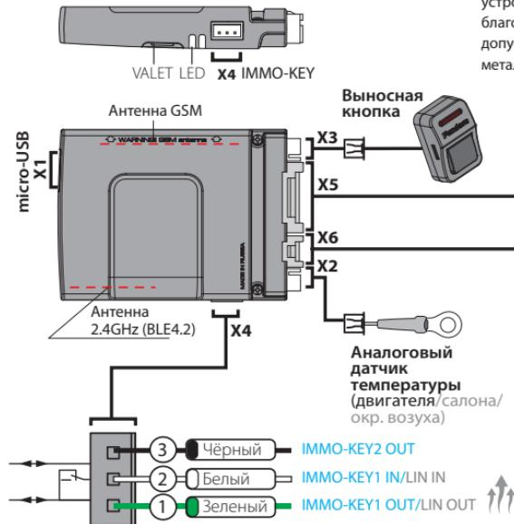
Разъём X4 – используется для обхода штатного иммобилайзера (подключается согласно карте установки размещённой на сайте loader.alarmtrade.ru или в программе Pandora AlarmStudio) или для управления цифровыми подогревателями Webasto Thermo Top Evo, Eberspacher Hydronic 1/2/3 (Пункт 3.5.1 Использовать IMMO-KEY порт как LIN).
